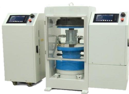
El ensayo triaxial se efectúa con una probeta de roca colocada dentro una cámara (célula de hoek) envuelta en una membrana de látex. Según las NORMAS: EN 1926, EN 14580 | ASTM D7012 | ASTM D2664 | ASTM D3148 | ASTM D5407.
